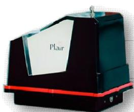
Le PLAIR (PA-300), comme le WIBS, permet de différencier les particules biologiques des autres. La haute spécificité du détecteur permet d'identifier plusieurs espèces simultanément et de bien déterminer les concentrations des aérosols atmosphériques.
