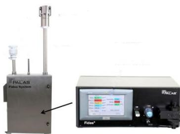
Le FIDAS 200 est certifié par le TÜV pour la mesure des fractions PM<sub>10</sub> et PM<sub>2,5</sub> ; il permet la mesure en temps réel de la distribution granulométrique en nombre et en masse des particules, dont notamment les pollens grâce à une gamme de mesure adaptée (de 2 à 100 µm).
